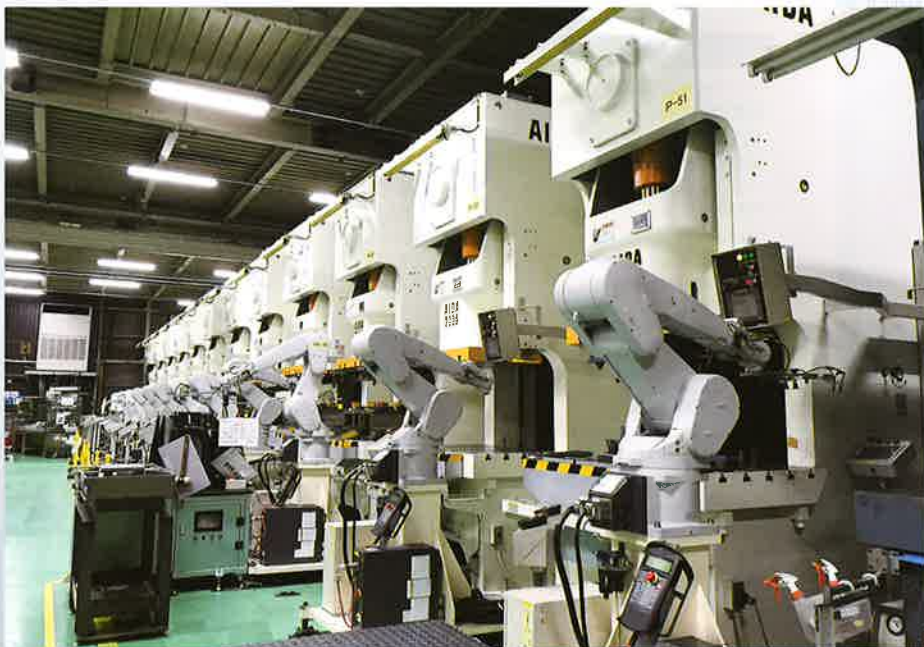
13連垂直多関節ロボットライン(200t×13)
