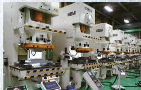
プレス機口ロボットライン200t×3+160t×5
